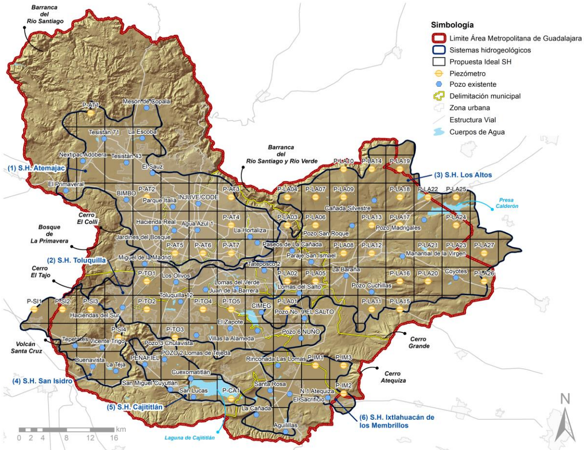
Figura 81. Propuesta factible del sistema de control hidrogeológico.
