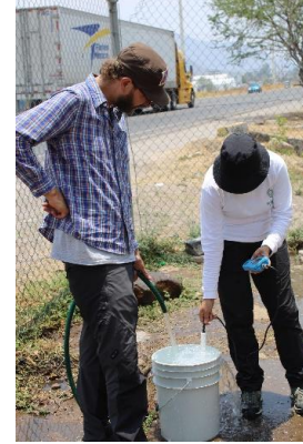
Purga y prueba in situ
