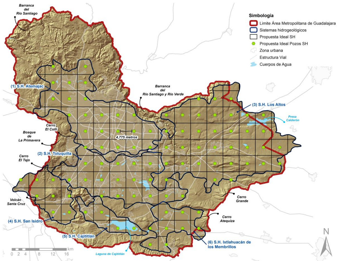
Figura 78. Propuesta ideal del sistema de control hidrogeológico.
