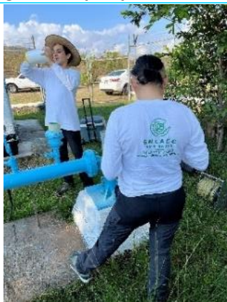
Toma de medición con sonda sónica. Revisión de muestras sin aire
